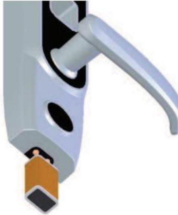
Si apaga un bloqueo de huellas dactilares sin cerrar el bloqueo durante el uso de alimentación externa, el cilindro de la cerradura no volverá automáticamente a su posición original. Es decir, el bloqueo de huellas dactilares permanece en estado NO. Para resolver este problema, puede reemplazar la batería y luego abra la cerradura una vez para tener el cilindro de la cerradura en su lugar.
