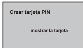
2) Cuando se le solicite ingresar el número de ID de usuario, presione **Y/y** para seleccionar el ID de usuario deseado y presione **ESTÁ BIEN**. Luego, el sistema le solicita que "Mostrar el tarjeta" (Si el ID de usuario seleccionado no existe en el sistema, el sistema mostrará un mensaje "No Inscribirse"), como se muestra en la figura de la izquierda:
