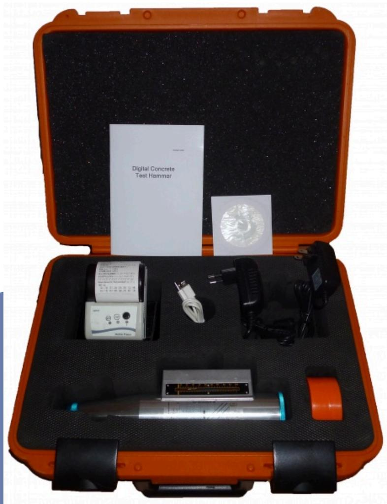
Fácil de generar informe por impresora en el lugar. Eliminar automáticamente el valor excepcional y calcular los resultados de los componentes. Posibilidad de almacenar, visualizar y transferir datos a una PC con interfaz USB.
