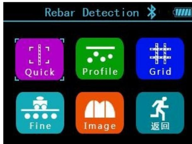
Fig.3.2 Interfaz principal de detección de barras de refuerzo
