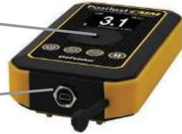
Importante: Asegúrese de que la cubierta protectora del USB esta sobre el puerto USB antes de realizar las mediciones.
